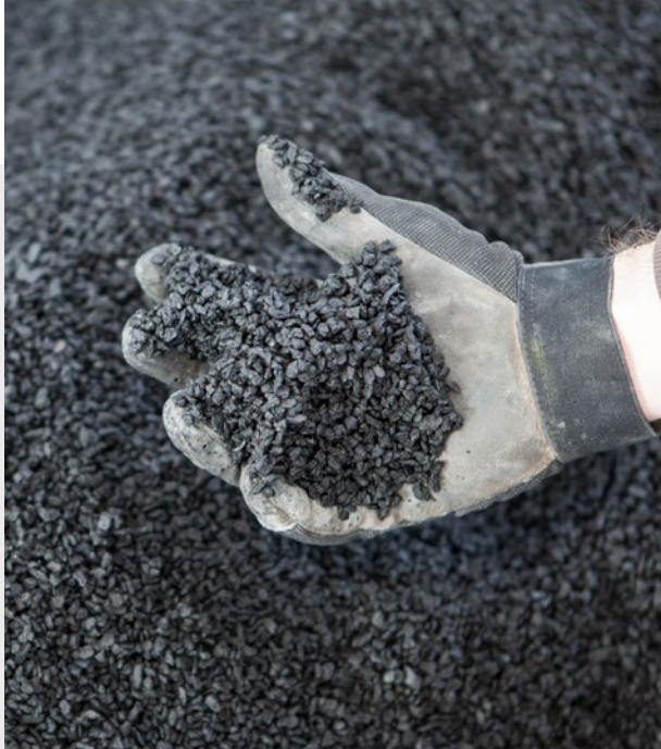
Im Recyclingprozess entsteht Plastik-Regranulat, aus dem zum Beispiel Kabelschutzrohre oder Putzmittelflaschen hergestellt werden.
